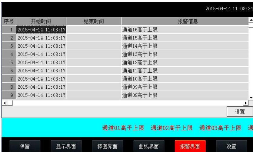
**设置：**显示界面下的设置按钮，通过此按钮可以进入参数设置和系统设置。点击设置选择参数设置（新仪器出厂默认没有密码，密码直接空着点击确定）
