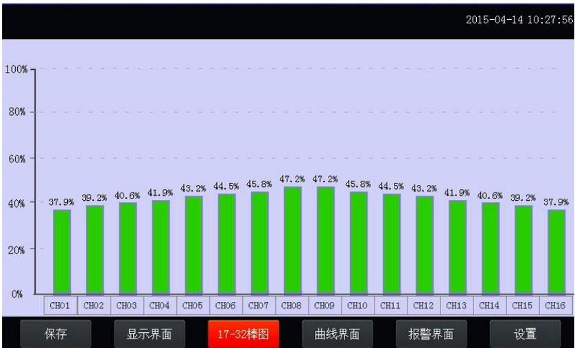
上图显示出棒图界面通道的具体内容，其中包含通道名称，数值和百分比棒图显示。棒图通道也具有报警功能，当通道值大于上限报警值或者小于下限报警值时，百分比填充颜色会变成红色，显示单位为百分比。
