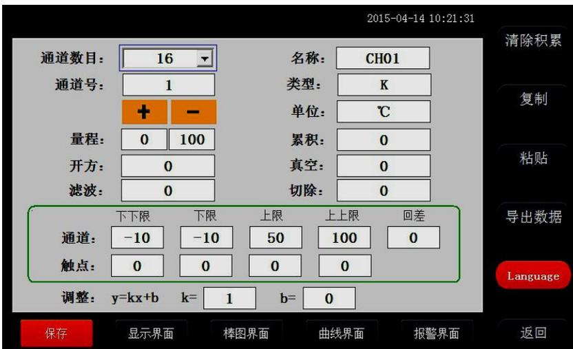
在参数设置界面里面可以对各项参数进行设置，显示通道的数目，通道名称，通道号的类型、量程、单位等各项参数进行设定。对于真空、累积、真空、开方滤波、切除等按钮是针对订制类产品进行设置的，如气体流量，水流量等进行设
