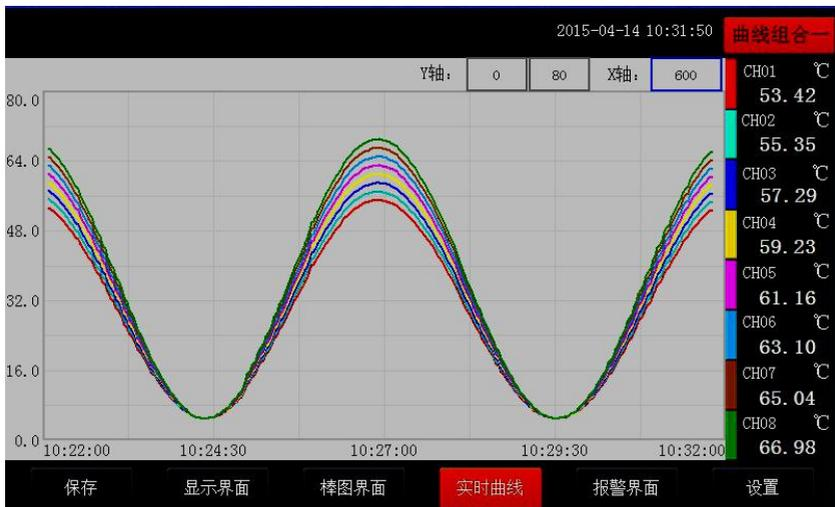
在实时曲线下显示当前通道的测量值，通道号，工位号，工程量单位，曲线的打点间隔，报警状态。
